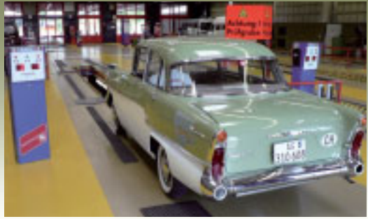
Immer geradeaus: Auf der Spurplatte werden Spur und Sturz gemessen. Ab 8 m/km wirds unsicher.
