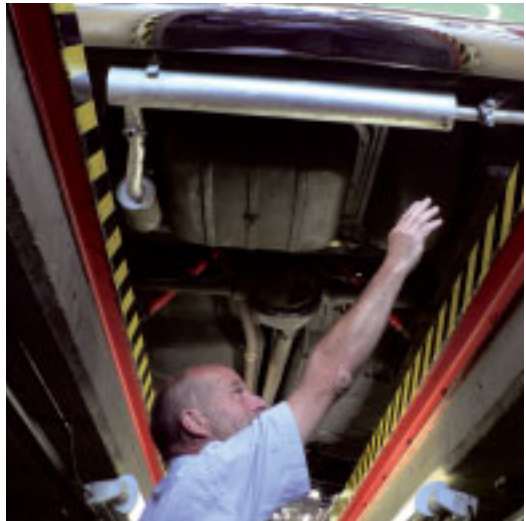
Bis hierher und nicht weiter: Der Auspuff darf nicht über die hintere Stossstange herausragen.
