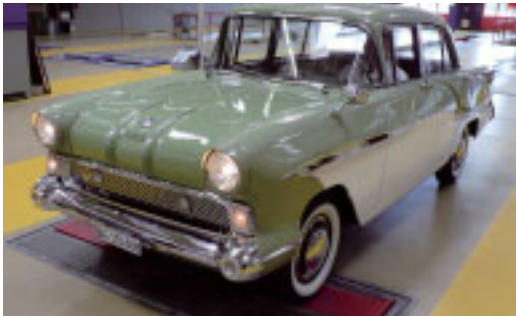
Swing: Die Stossdämpfer dürfen mit maximal 30% Unterschied nachschwingen...
