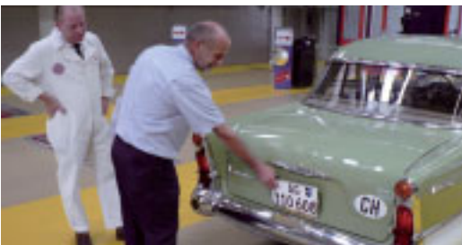
Keine «Hinterleuchtung»: Das Nummernschild muss auch bei Wechselrahmen gut beleuchtet sein.
