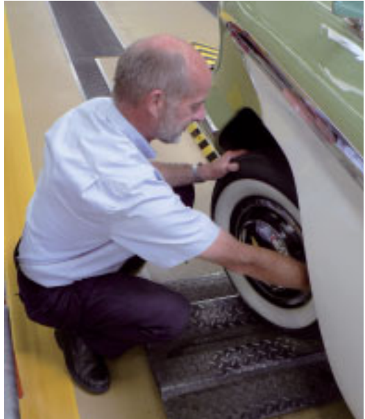
Reifenprüfung: keine Risse, keine Blasen, genug Profil. Die Diagonalreifen des Vauxhall sind einwandfrei.
