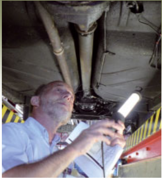
Bodenprobe: Flugrost wird toleriert, Blasen und Durchrostungen nicht. Beim Vauxhall findet der Experte weder noch.
