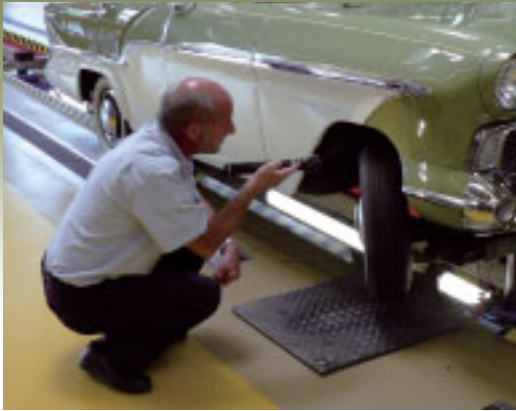
Blick in den Kasten: Aufhängung und Bremsen werden auch von oben kontrolliert.
