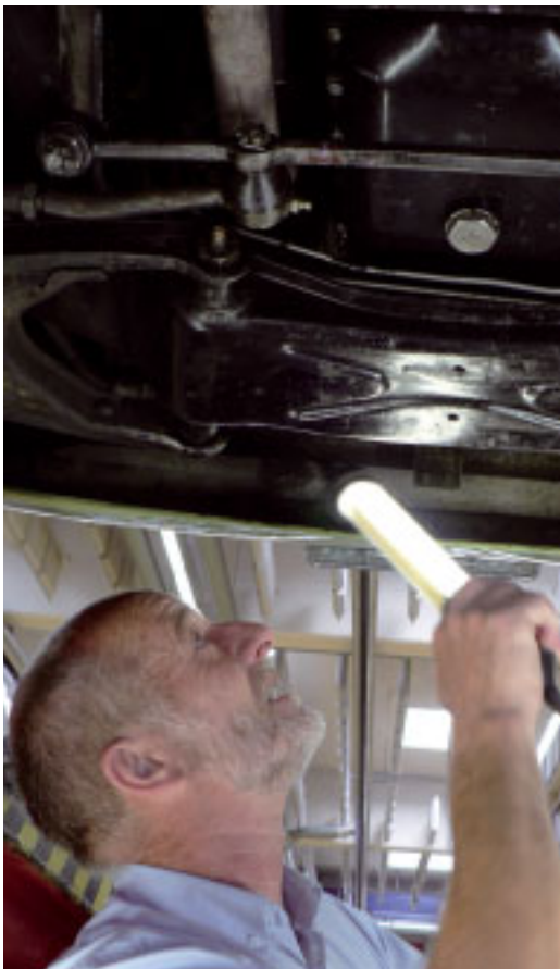
Steter Tropfen höhlt den Asphalt: Ölwanne und Getriebe müssen so dicht sein, wie sie bei der Erstinverkehrsetzung waren.
